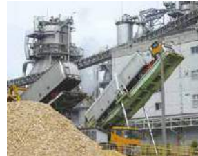
圧巻! トラックごと斜めにチップを運搬。
