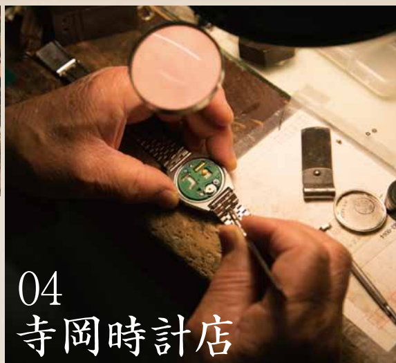
腕時計の裏蓋を専用工具であげ、ドライバーとピンセットで電池交換を行う。非常に細かな部品を扱い丁寧に作業を進める。
